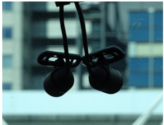
<操舵室前方に取り付けた通信型ドライブレコーダーのカメラ>
