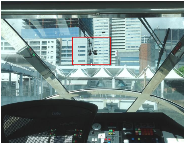
<操舵室前方に取り付けた通信型ドライブレコーダーのカメラ>
