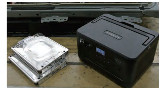
製品に使用されるリーフの再生バッテリーセル(左)と開発中の製品イメージ(右)
