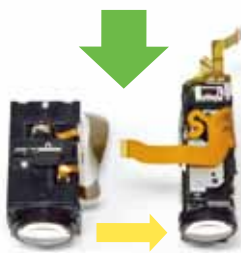
レンズユニットの小型化 幅28mm→20mm
