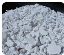
水晶をエッチングする工程で発生するスラッジはインターロッキングブロック等に再生されます。
