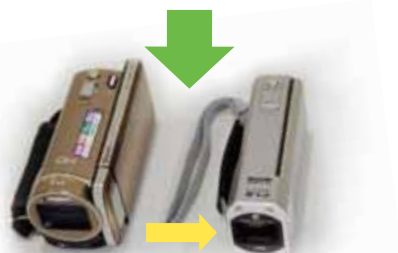
本体の小型化（薄型化） 幅54mm→38mm
