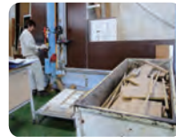
家具の製造工程で発生した廃材は熱エネルギーとしてサーマルリサイクルしています。
